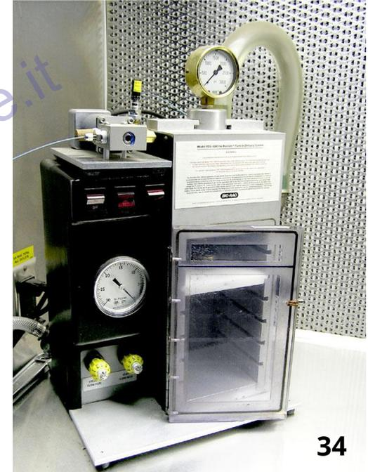
Strumento per il trasferimento di microparticelle
